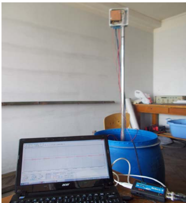
ნახ.2. მეწყრის ცოცვის მოდელირება და თანმხლები აკუსტიკური ემისიის რეგისტრაცია USB ოსცილოსკოპის საშუალებით
