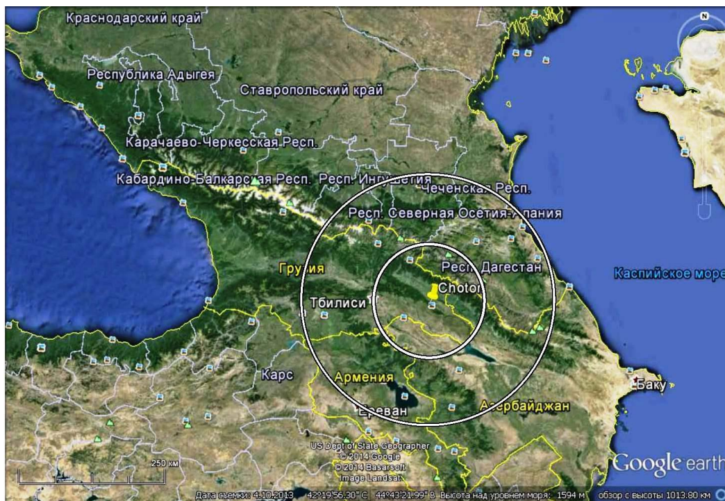
Рис. 2 Зона действия радиолокатора типа METEOR 735CDP10 фирмы Selex на территории Восточной Грузии и сопредельных стран.
