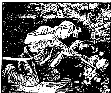
Рис. 251. Применение пневматического молотка в рудниках.
