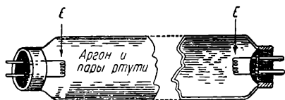
Рис. 579. Устройство люминесцентной лампы.
