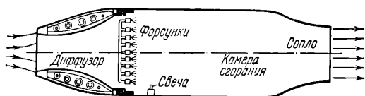
Рис. 286. Схема прямоточного воздушно-реактивного двигателя.
