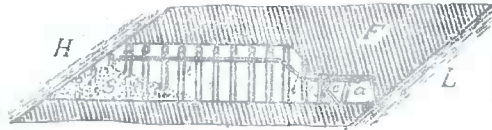
ნახ. 507. ჰიდრაულური ესების წარმოება სპირაჯოში. H, L—სახურავი და საგები გვერდები; F—ქეანახშირის მსხვი; S—ჰიდრაულური ესება; a—საშრეო შტრეკი; c—სპირაჯოს ვიწრო ნაწილი; k—ზღუდარი; t, t—სავსებო მილსადენი.
